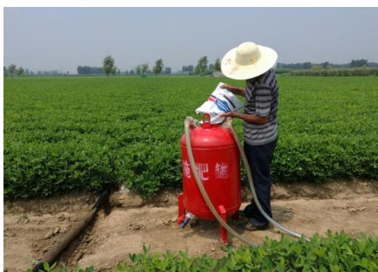
图 4 水肥一体化施肥装置
